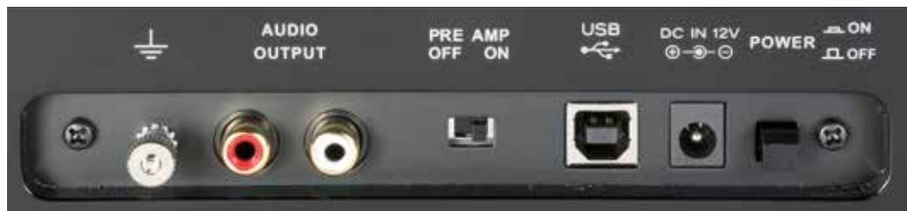
Die Signale liegen analog an einem Paar Cinch-Buchsen sowie digital (16 Bit/44,1 Kilohertz) an einer USB-Schnittstelle an. Bei Verwendung eines externen lässt sich der integrierte Phono-Pre ausschalten.
